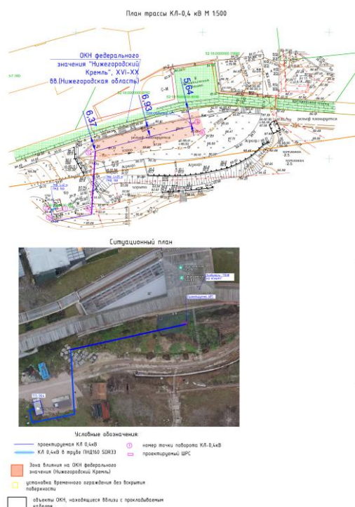
Рис. 1. План трассы КЛ-0,4 кВ, ситуационный план шифр 68/24-1988-08-ЭС.
